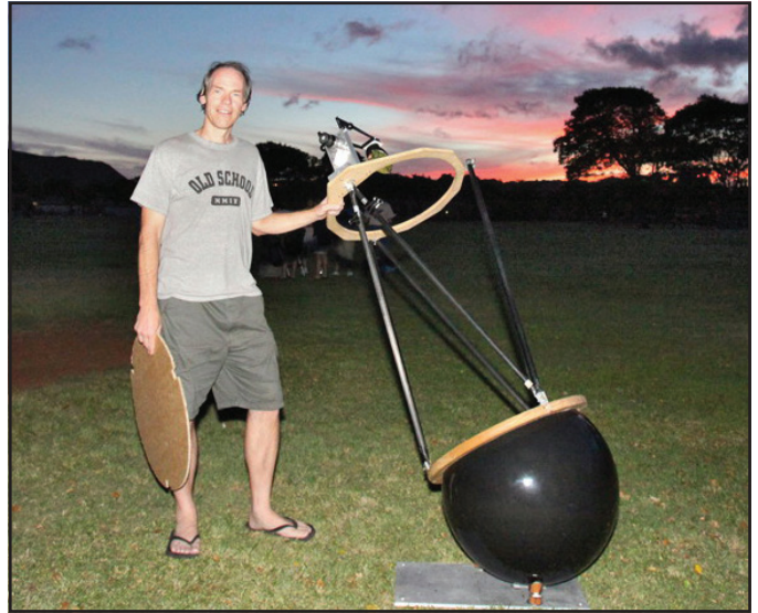
Mike Linnolt (LMK) avec son télescope de Newton à montage sphérique de 500 mm f/3,6 de fabrication personnelle.
