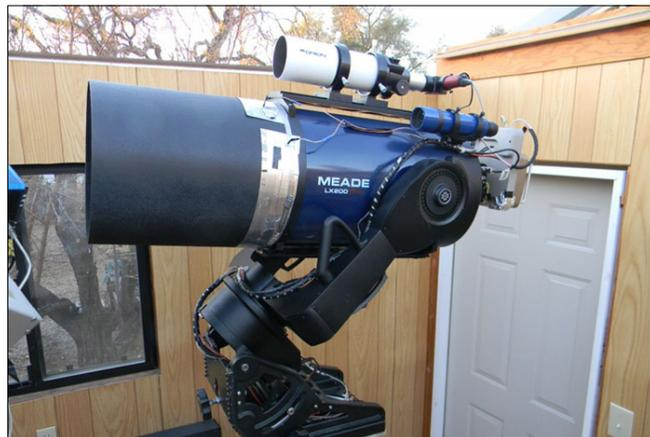
*Dos de los telescopios de la red AAVSOnet: BSM-Hamrem, 65 mm, Astro-Tech AT-65EDQ (izquierda) y Coker 30, un Schmidt-Cassegrain de 30 cm, Meade LX-200 GPS (derecha).*
