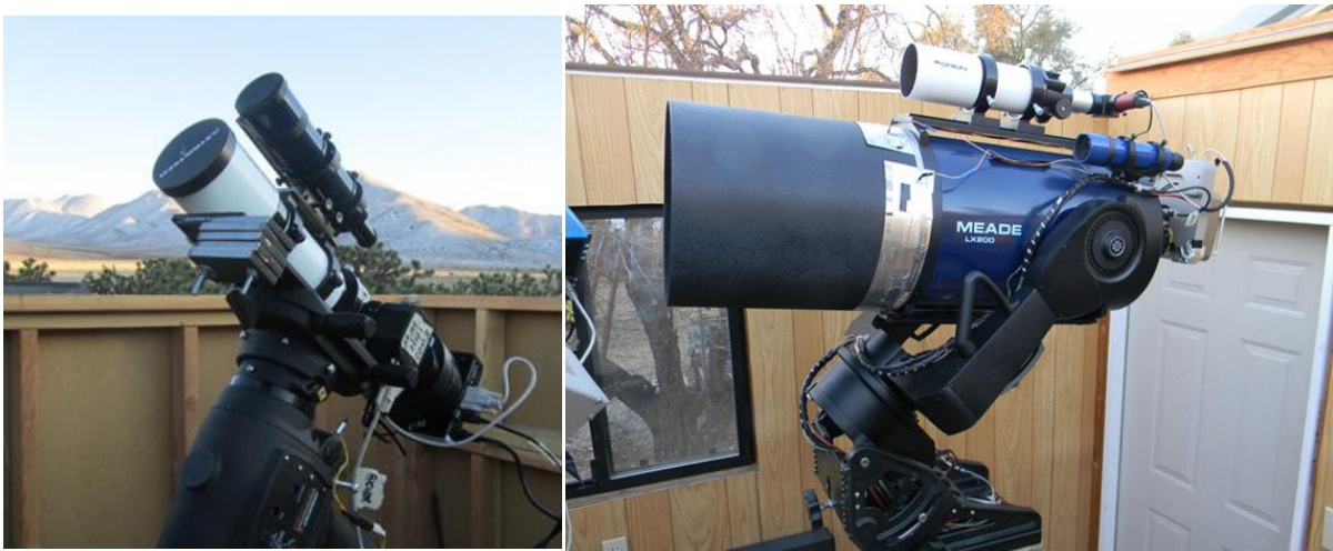
Δύο από τα τηλεσκόπια του AAVSOnet: το BSM-Hamren AT-65EDQ της Astro-Tech (αριστερά) και το Coker 30, ένα Meade LX-200GPS 30 εκατοστών (δεξιά)
