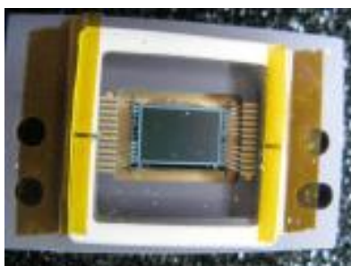
Παράδειγμα ενός παλαιότερου τύπου CCD τσιπ. Η περιοχή του αισθητήρα είναι το γκρι ορθογώνιο στο κέντρο. Προσέξτε τη συνδεσμολογία στα άκρα του. Το CCD διαβάζεται μέσω αυτών των αγωγών που συνδέονται με τον αναλογικό-προς-ψηφιακό μετατροπέα, μέσα στην κάμερα. (με τη άδεια του Arne Henden)
