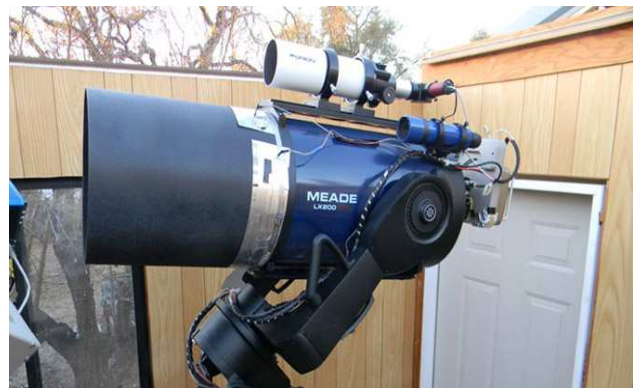
Deux télescopes AAVSONet : BSM-Hamren, Astro-tech 65mm AT-65EDQ (à gauche) et Coker 30, un Meade 30cm LX-200GPS (à droite).
