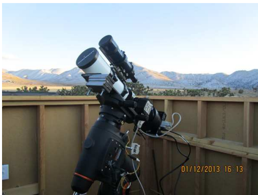
Deux télescopes AAVSONet : BSM-Hamren, Astro-tech 65mm AT-65EDQ (à gauche) et Coker 30, un Meade 30cm LX-200GPS (à droite).
